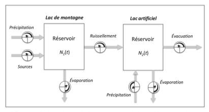
**FIGURE 1.5** – Exemple de système à plusieurs réservoirs (plusieurs éléments) et plusieurs entrées et sorties pour chaque réservoir (élément du système). L'idée ici est de modéliser l'évolution de la quantité d'eau dans un lac artificiel alimenté par un lac de montagne.
